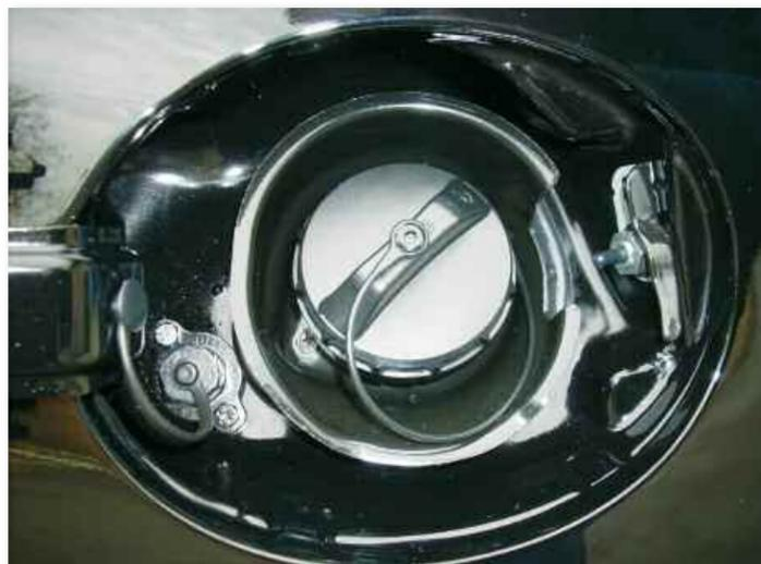
La presa di carico del GPL è inserita all'interno dello sportellino per il rifornimento a benzina per non compromettere la riuscita linea della CX-7.
