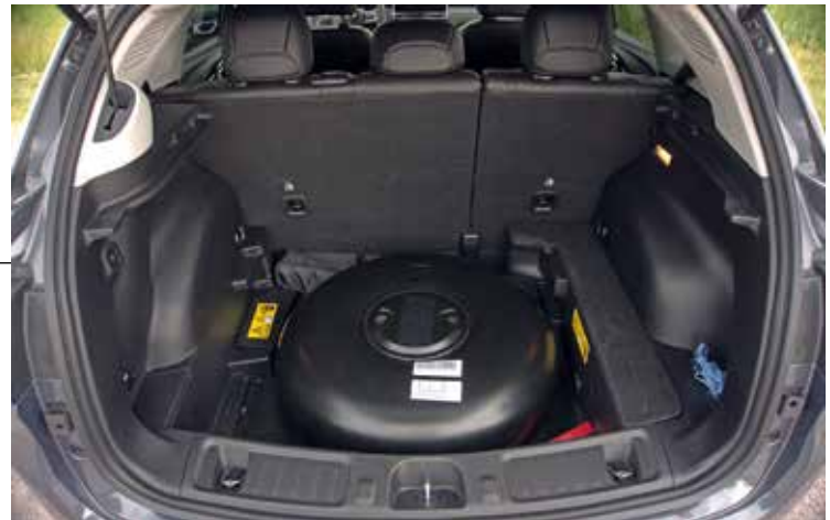
Il serbatoio da 60 litri lordi non ruba spazio nel baule e allunga l'autonomia di oltre 500 km.
