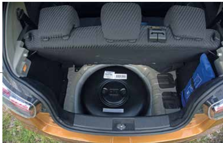
Sotto il vano di 243 litri c'è il serbatoio del GPL da 34,5 litri effettivi per autonomie di oltre 400 km.
