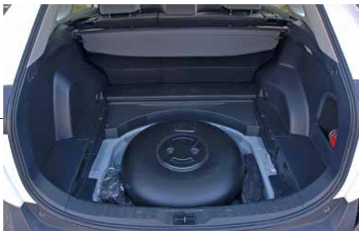
Il serbatoio del gas di 58 litri lordi sotto il piano di carico lascia inalterato il bagagliaio di 580 litri.
