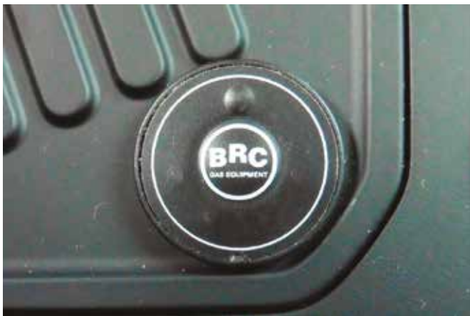
The switch from petrol to LPG and vice versa is located near the gearbox. Il commutatore per i passaggi benzina GPL è vicino al cambio.
