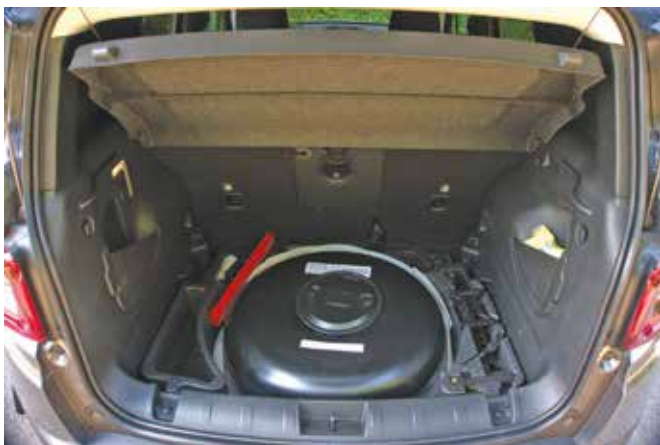
The toroidal tank is placed in the spare wheel compartment. Il serbatoio toroidale al posto della ruota di scorta.
