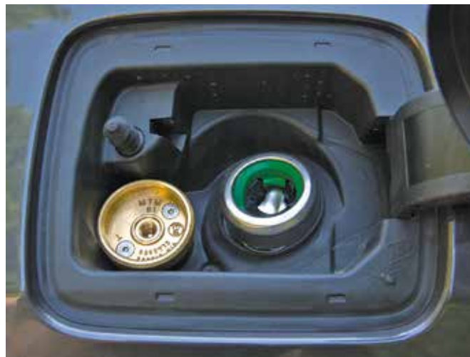
The inlet also includes an adapter. La presa di carico comprensiva di adattatore.
