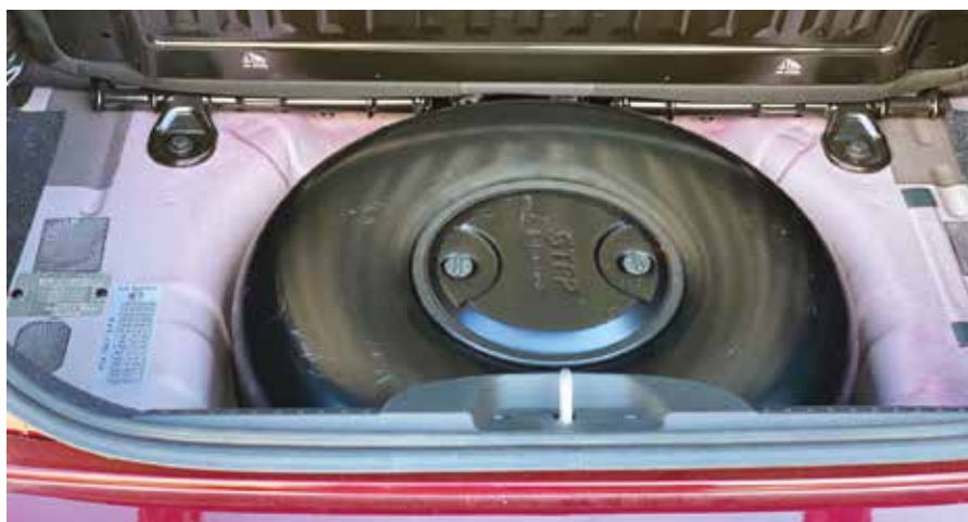
Il serbatoio toroidale, installato nel vano ruota di scorta. The toroidal tank, in the spare wheel compartment.
