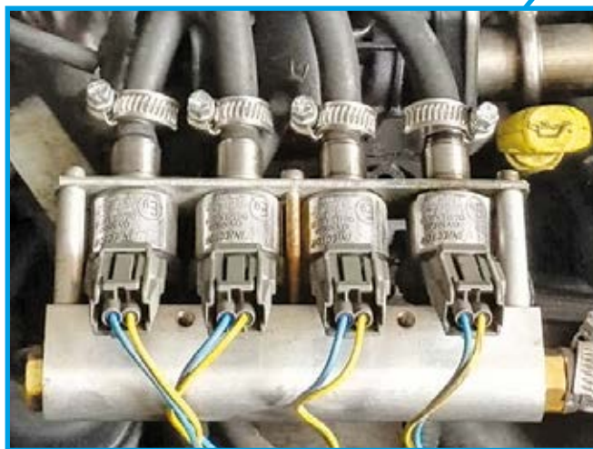
L'alimentazione dual fuel con GPL incrementa potenza e coppia del 2.0 Citroën fino a 125 CV e 330 Nm.
