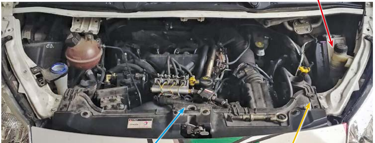
L'alimentazione dual fuel con GPL incrementa potenza e coppia del 2.0 Citroën fino a 125 CV e 330 Nm.
