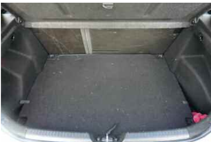
Il serbatoio del GPL da 48 litri non influisce sulla capacità del bagagliaio di 378 litri, 1.316 litri reclinando il divano posteriore.
