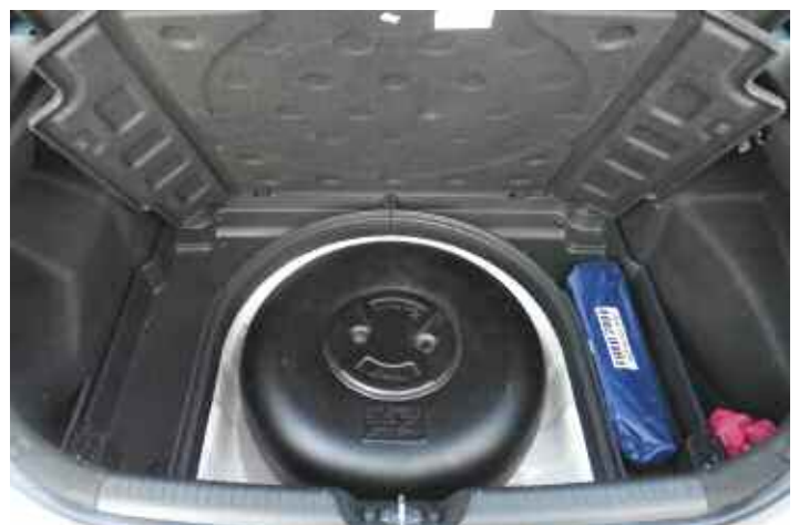
Il serbatoio del GPL da 48 litri non influisce sulla capacità del bagagliaio di 378 litri, 1.316 litri reclinando il divano posteriore.
